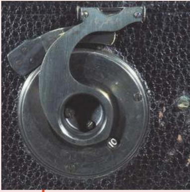
☞ *Clef en position « prise de vue ». Le magasin est parallèle à la face avant de l'appareil, la surface sensible du film en regard de l'objectif.*
