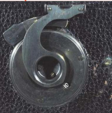
☞ *Quand on ramène la clef à sa position de départ en la tournant dans le sens horaire, le guide de la rampe suit une sorte d'aiguillage qui lui fait suivre un chemin différent au retour pour permettre aux ergots mobiles de retrouver leur position initiale pour le film suivant.*
