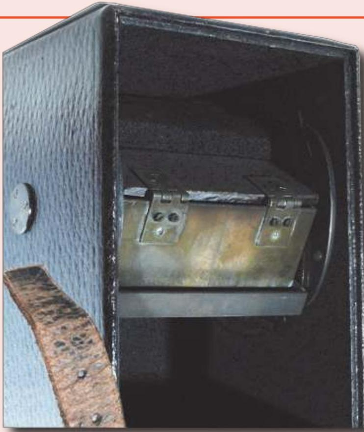
*Cette vue montre le magasin fermé et la toile qui assure l'étanchéité à la lumière de l'emplacement où restent stockés les films impressionnés.*
