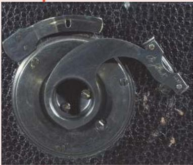
☞ *La clef passe au-delà de la butée rétractable pour pouvoir décrocher le papier protecteur du magasin.*
