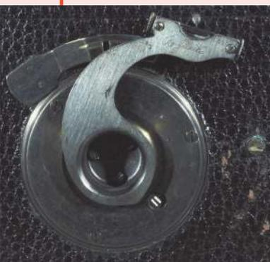
☞ *Quand la clef de rotation est positionnée comme dans la photo ci-dessus, le magasin est incliné et permet une correction de la perspective dans le cas de photos d'architecture.*
