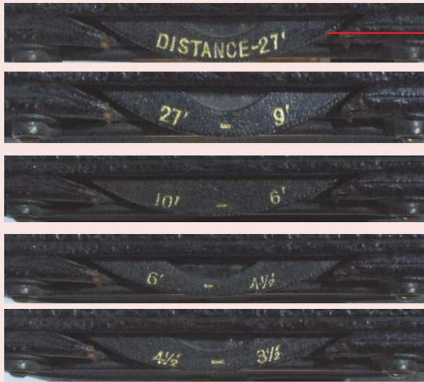
*Réglage de la distance par mise en place de lentilles additionnelles.*
