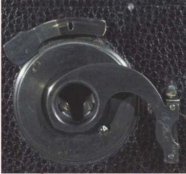
☞ *La clef a été tournée de 270 ° sens antihoraire. Le magasin est parallèle à la base de l'appareil, la surface sensible du film tournée vers la base de l'appareil. Le film exposé se détache du magasin.*
