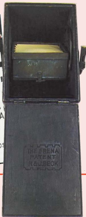
Dans le Frena n°1, le magasin n'est pas amovible. Il est entraîné par un axe de rotation solidaire d'une clef externe à l'appareil. Cette clef est munie d'un niveau.
