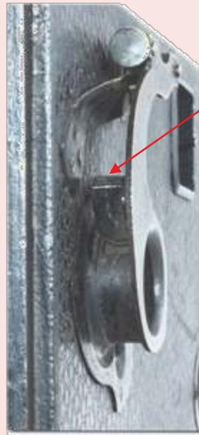
*Dans cet appareil il y a une sécurité qui interdit de tourner le levier de changement de film quand l'appareil n'est pas vertical, l'objectif en haut.*
