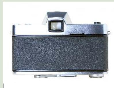
Le Kowa H est un 24x36 reflex à obturateur central, objectif fixe à présélection automatique et miroir éclair .
