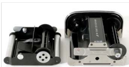
A gauche, porte-pellicule du Primarflex, à droite, celui du Hasselblad
