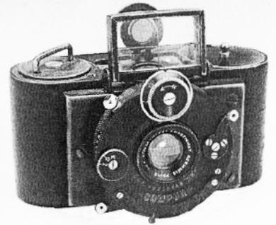
Avec son obturateur Compur dial (fabriqué j.1928) de dimension «00», cet imageur semble bien être l'archétype des Furets Type 3 . Objectif Hermagis Anastigmat f 3,5, apparemment fixfocus . Chargeur récepteur avec clé atypique (similaire à celle du brevet de 1924 - v. page 12) .
