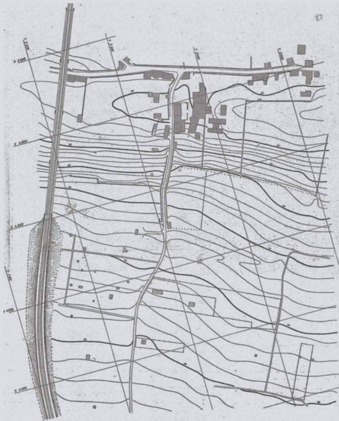
A gauche, spécimen d'une fraction d'un plan au 1/1000 ème , exécuté dans la région de Saint-Germain-en-Laye pour le Ministère de l'Air. Les courbes de niveau sont à l'équidistance de 1 mètre. A droite, spécimen d'une fraction d'un plan au 1/5000 ème exécuté en région très accidentée, avec courbes de niveau à l'équidistance de 5 mètres.
