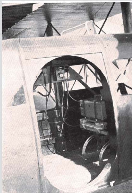
Photographie de l'intérieur d'une carlingue d'un avion de travail montrant un Aérophoto GR' en position de travail ainsi que le poste des commandes.
