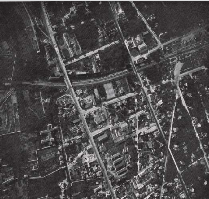
Couple de clichés pris avec deux appareils Cadastro conjugués. On remarquera que les détails du sol situé à gauche sur le cliché de gauche et à droite sur le cliché de droite, sont à une plus petite échelle que l'autre côté de chaque photographie. Ceci est dû à la position inclinée des deux appareils Cadastro telle qu'elle est présentée page 6.
