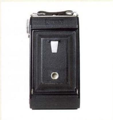
ABATTANT 72x103 mm en tôle emboutie avec saillie pyramidale (épaisseur 9mm), béquille rabattable et écrou de pied au pas du Congrès ; charnière d'abattant côté charnière de boîtier .
