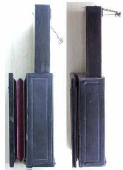
Magasin en position d'exposition de la plaque 1 à gauche et 6 à droite.
