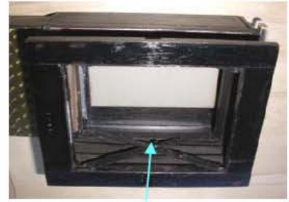
Détail de la liaison entre la partie antérieure et le fond du magasin
